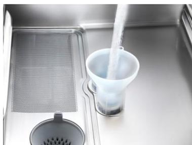
Trichter in die Einfüllöffnung des Salzbehälters setzen und nach und nach 3 Beutel Winterhalter-Spezialsalz (=1,5kg) einfüllen. Trichter abnehmen und den Einfüllbereich von Salzresten säubern
