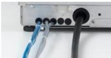
Netzanschlussleitung an der Rückseite der Maschine einführen und zu den Anschlussklemmen nach vorne führen.
