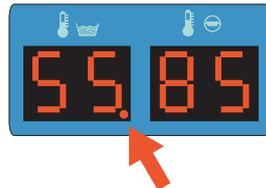
**Anm.: Die Auswahl der zusätzlichen Kühlung wird nicht gespeichert, sondern muss bei jedem Aus- und Wiedereinschalten der Maschine neu eingestellt werden (wenn diese Funktion gewünscht wird).**
