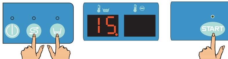
Wenn das Passwort korrekt eingegeben wurde, erhält man Zugriff auf den Parameter; ansonsten wird 4 Sekunden lang eine Fehlermeldung "Err" angezeigt.
