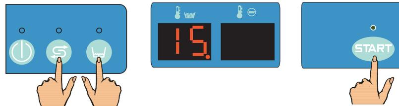
Bei Geräten, die mit dem optionalen Zubehör der **Regeneration** ausgestattet sind, blinkt das LED "A" schnell und anschliessend erscheint einige Sekunden lang auf dem Display die Meldung: **Hard**.
