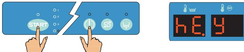
Mit den Tasten "K" (senken) und "L" (erhöhen) den Schlüssel "15" anwählen. Die Anwahl durch Drücken der taste "H" bestätigen.
