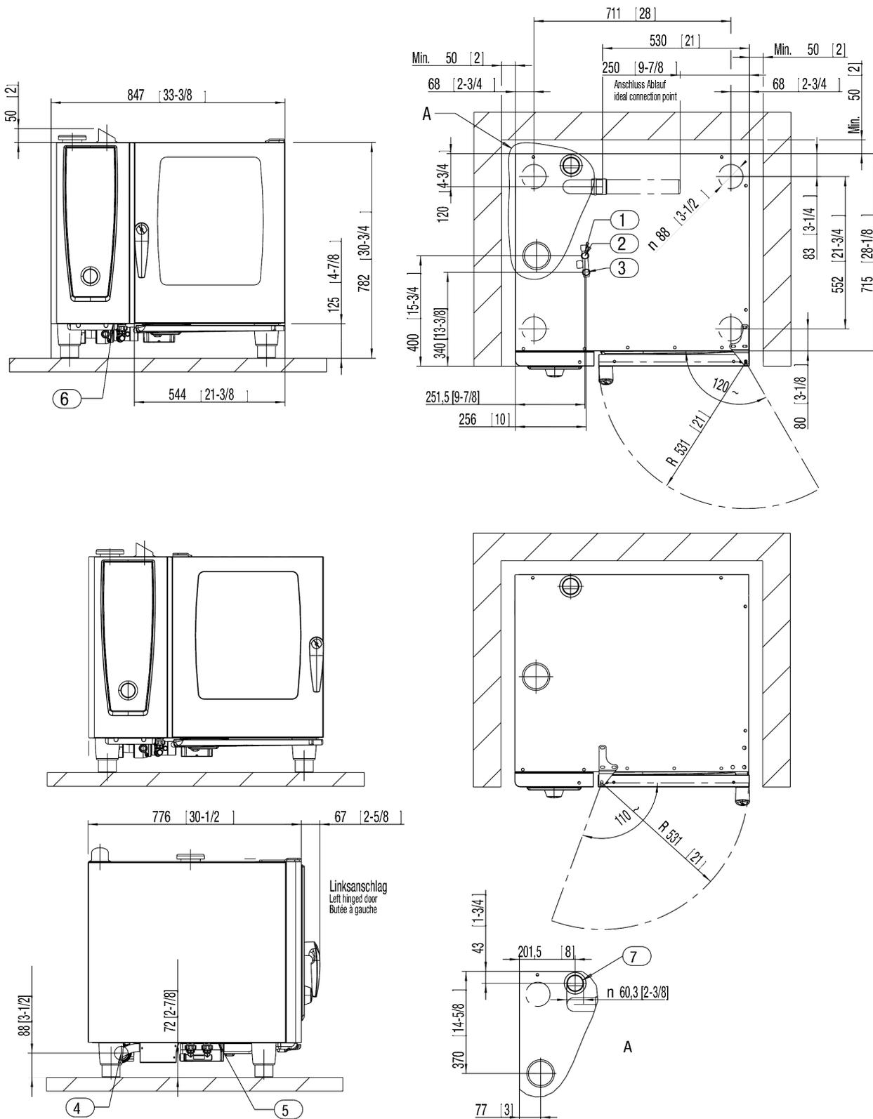
1. Gemeinsamer Wasserzulauf (Kaltwasser) 2. Wasserzulauf Kaltwasser 3. Wasserzulauf Weich- bzw. Warmwasser 4. Wasserablauf 5. Elektroanschluss 6. Potentialausgleich 7. Entlüftungsrohr DN 60 Mindestabstand 50 mm Maße in mm (inch)
