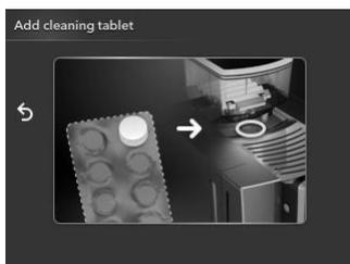
5. Öffnen Sie die Abdeckung vom Mahlwerk und fügen Sie die Reinigungstablette ein. Schließen Sie die Abdeckung und drücken Sie zur Bestätigung „MENU / OK“.
