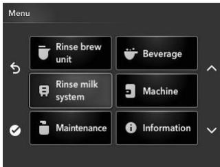
1. Drücken Sie die Taste „MENU / OK“, wählen Sie die Option „Milchsystem reinigen“ aus und bestätigen Sie mit „MENU / OK“.
