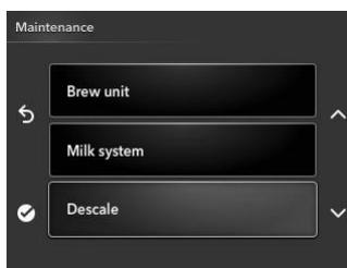
1. Wenn nach einer bestimmten Zeit der Ablagerungsgrad erreicht ist, werden "Maschine entkalken" und "Drücken", "Spülen" abwechselnd in der Display-Anzeige erscheinen. Wählen Sie im Programmenü „Wartung“ aus.
