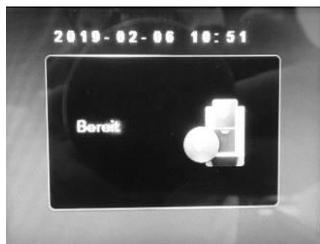
3. Nachdem die Reinigung des Milchsystems abgeschlossen ist, geht das Gerät in den Modus „Bereit“.
