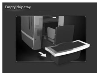
6. Reinigen Sie den Auffangbehälter mit warmem Wasser.
