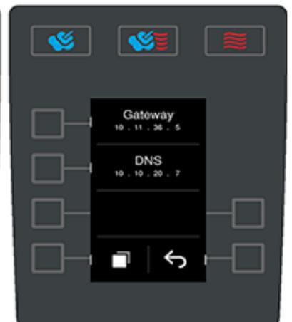
Hier werden DHCP Nummer, IP-Adresse, Subnetmaske, Gateway und DNS angezeigt. Desweiteren wird hier auch die MAC-Adresse angezeigt. So kann die Netzwerkverbindung z.B. in einer Firmenumgebung zugeordnet werden durch den eindeutigen Identifikator des Netzwerkadapters des iCombi Classic (MAC-Adresse).
