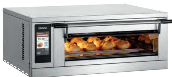
Backwaren vom traditionellen Backstein aus Schamotte mit getrennt regelbarer Ober- / Unterhitze. Der Etagenbackofen überzeugt auch bei Beschwadung mit einem geringen Temperaturverlust. Die externe Schwadengenerierung und der Schamottstein sorgen für eine nahezu konstante Temperatur in der Backkammer.
