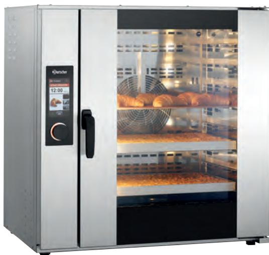
Perfekt auf die Backwaren abgestimmte Dampfgenerierung: Wahlweise über die externe Steam-Box oder über Direkteinspritzung - Für ein knuspriges Äußeres sorgt die AirFresh-Box des Konvektionsbackofen durch ein schnelles senken der Luftfeuchtigkeit. Der multiselektive Knebel mit mehrfarbiger LED-Beleuchtung ermöglicht eine intuitive Bedienung mit zusätzlich optischem Signal.
